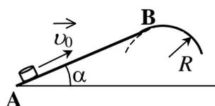
Небольшая шайба после удара скользит вверх по наклонной плоскости из точки А (см. рисунок). В точке В наклонная плоскость без излома переходит в наружную поверхность горизонтальной трубы радиусом  $R$ . Если в точке А скорость шайбы превосходит  $v_0 = 4 \text{ м/с}$ , то в точке В шайба отрывается от опоры. Длина наклонной плоскости  $AB = L = 1 \text{ м}$ , угол  $\alpha = 30^{\circ}$ . Коэффициент трения между наклонной плоскостью и шайбой  $\mu = 0,2$ . Найдите внешний радиус трубы  $R$ .
