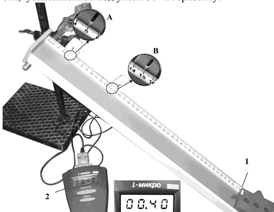
В момент начала движения верхний датчик (А) включает секундомер (2), а при прохождении каретки мимо нижнего датчика (В) секундомер выключается. Числа на линейке обозначают длину в сантиметрах. Какое выражение позволяет вычислить скорость каретки в любой момент времени?
