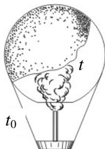
Воздушный шар, оболочка которого имеет массу  $M = 145$  кг и объем  $V = 230$  м<sup>3</sup>, наполняется горячим воздухом при нормальном атмосферном давлении и температуре окружающего воздуха  $t_0 = 0^\circ\text{C}$ . Какую минимальную температуру  $t$  должен иметь воздух внутри оболочки, чтобы шар начал подниматься? Оболочка шара неэластична и имеет в нижней части небольшое отверстие.
