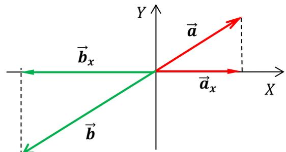
Рис. 6, б. Проекция умножения вектора на число:  $\vec{a}_x \ni X$ ,  $\lambda < 0$ .
